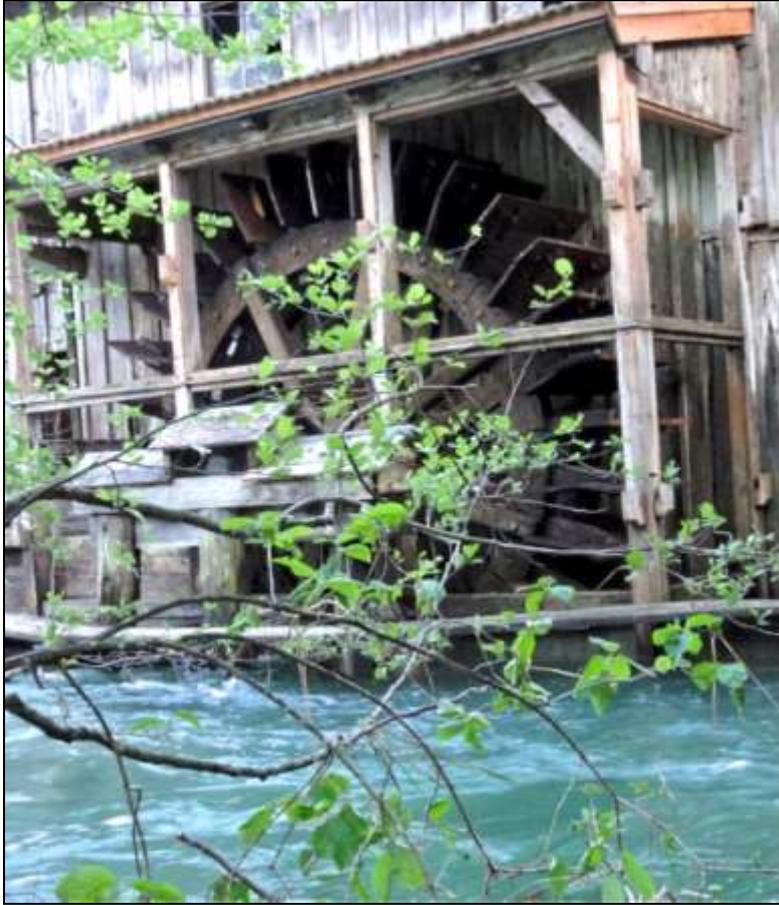
**Bild 57: Das Wasserrad des ehemaligen Sägewerkes, jetzt zum Antrieb eines Drehstrom-Asynchrongenerators verwendet. (Foto: Franz Fuchs, 6. Juni 2013).**
