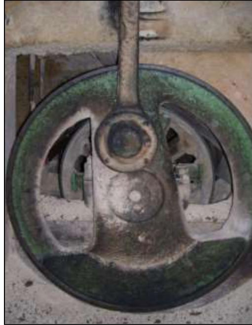
**Bild 64: Gatterantrieb über Exzenter - Scheibe. (Foto: M. Gschwandtner 25. Juli 2013).**
